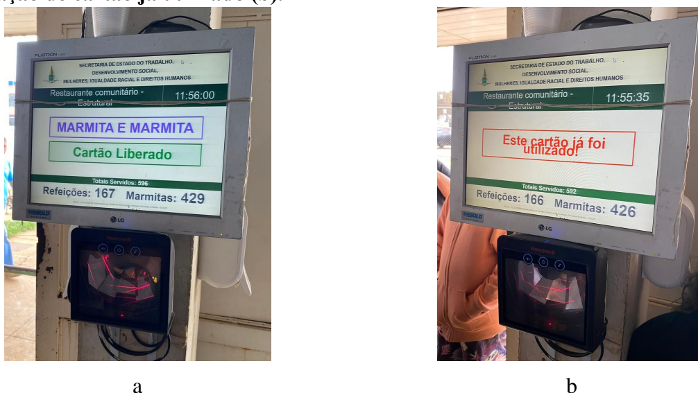
Figura 7 - Leitor óptico de controle após a validação do cartão vendido (a) e após tentativa de utilização de cartão já utilizado (b).
