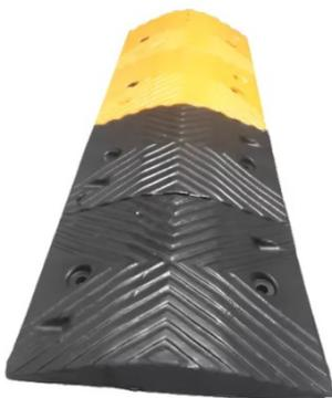
**09- Conjunto para acabamento de lombada modular:** em borracha reciclada de pneus e revestimento em borracha EPDM. Resistente a grande volume de tráfego e carga até 20 toneladas de eixo. Fixação por parafusos. 01 unidade na cor preta e 01 unidade na cor amarela, altura mínima:5cm (compatível com o item 8).
