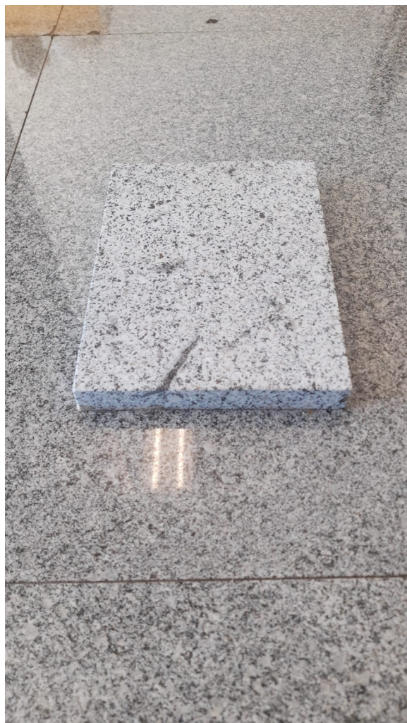
Amostra do piso de granito - face superior
