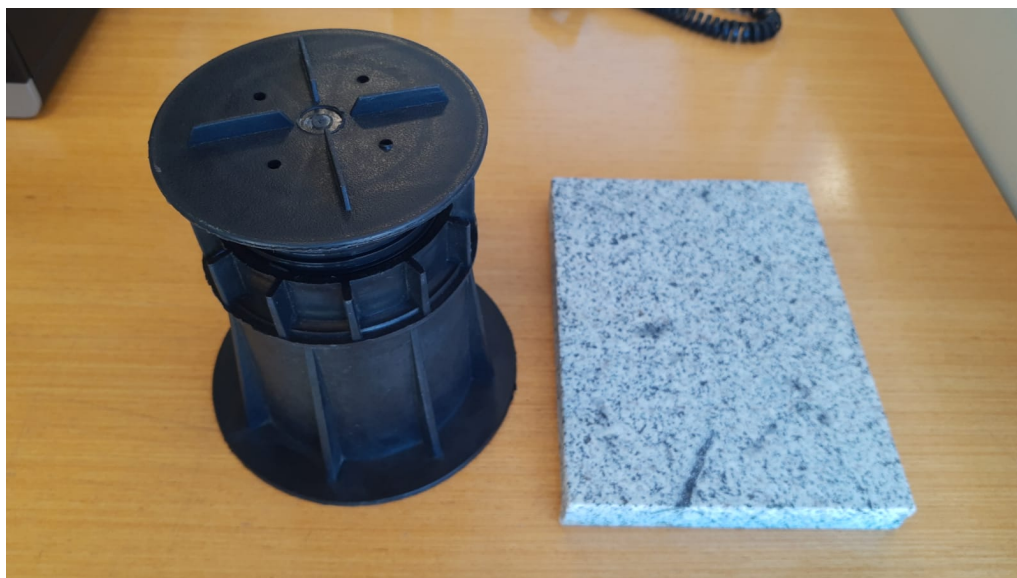
Amostra do piso de granito e amostra do suporte de piso
