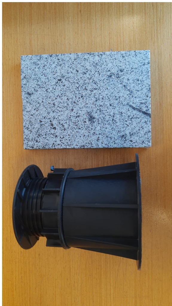
Amostra do piso de granito e amostra do suporte de piso
