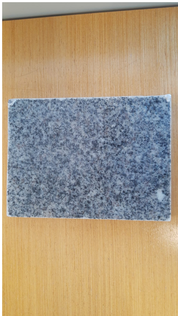
Amostra do piso de granito - face inferior com fibra de vidro
