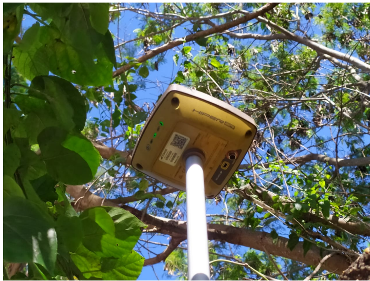
Foto 5: Receptor Topcon GNSS Hiper SR utilizado para aferição sub-métrica de pares de coordenada
