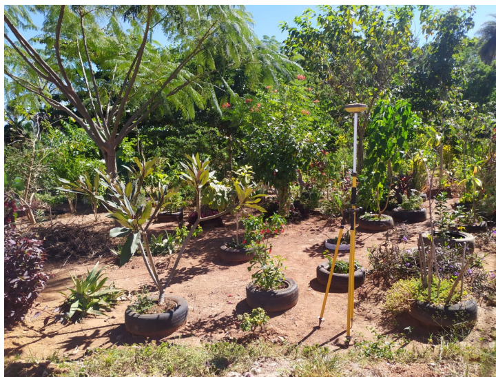
Foto 6: plotagem de pontos, método de Posicionamento relativo estático-rápido
