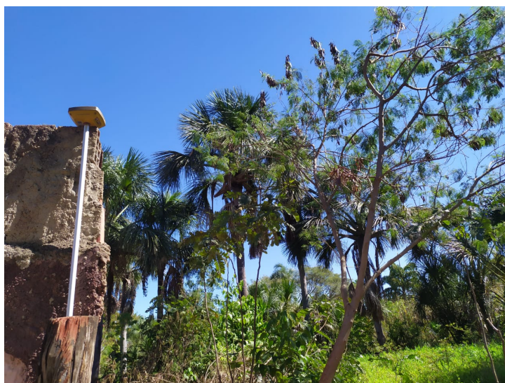
Foto 7: plotagem de pontos, método de Posicionamento relativo estático-rápido
