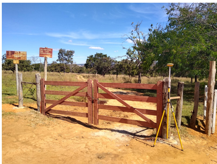
Foto 10: plotagem de pontos, método de Posicionamento relativo estático-rápido
