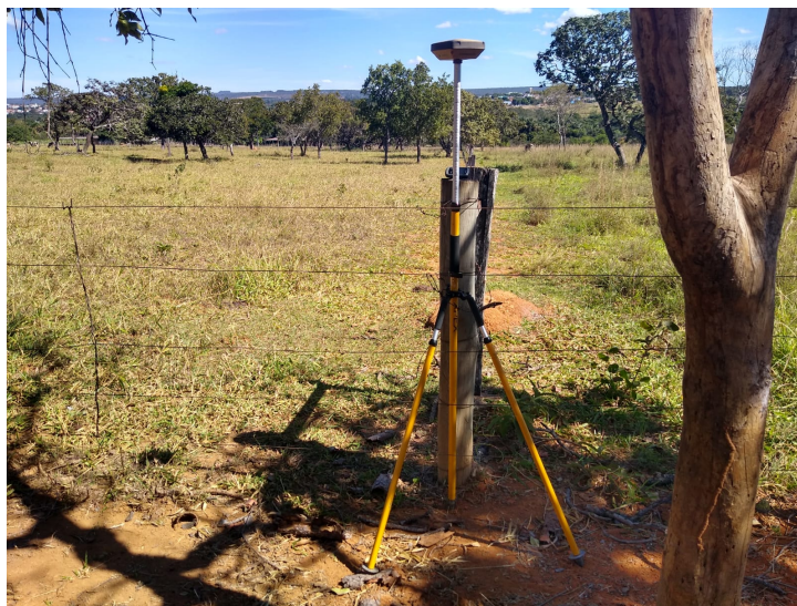
Foto 9: plotagem de pontos, método de Posicionamento relativo estático-rápido
