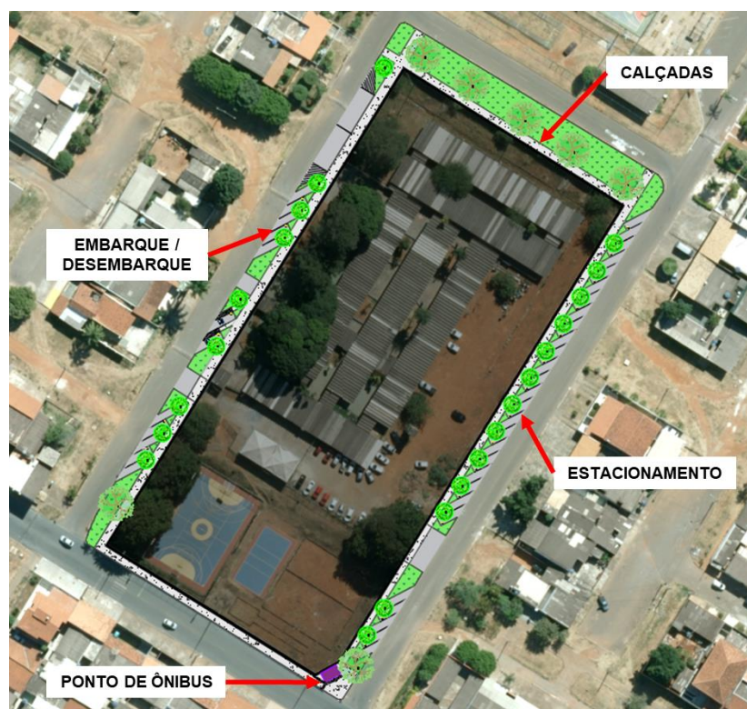
Figura 4 – Proposta para calçadas, estacionamentos e ponto de ônibus para o entorno do Centro Educacional 08
