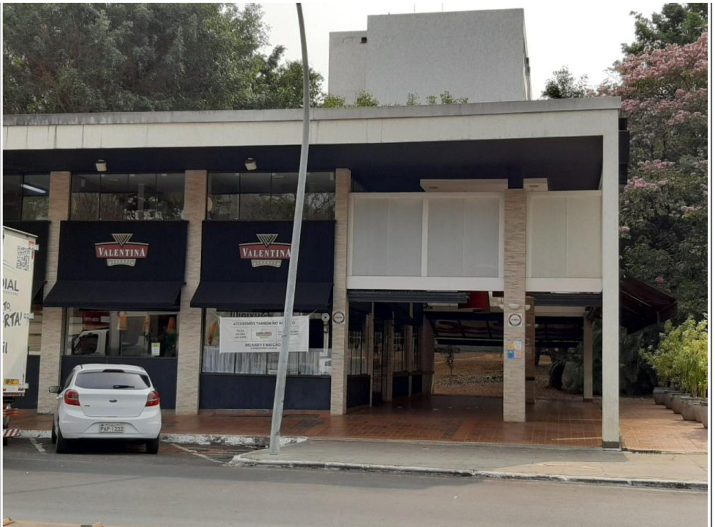
Figura 9 - Estabelecimento com ocupação lateral de bloco (pizzaria "Valentina", CLS 310, bloco A), que utiliza corretamente os elementos permitidos pela lei vigente (toldos, painéis fixos a mais de 2,20m do piso), deixando o espaço livre fora do horário de funcionamento do comércio
