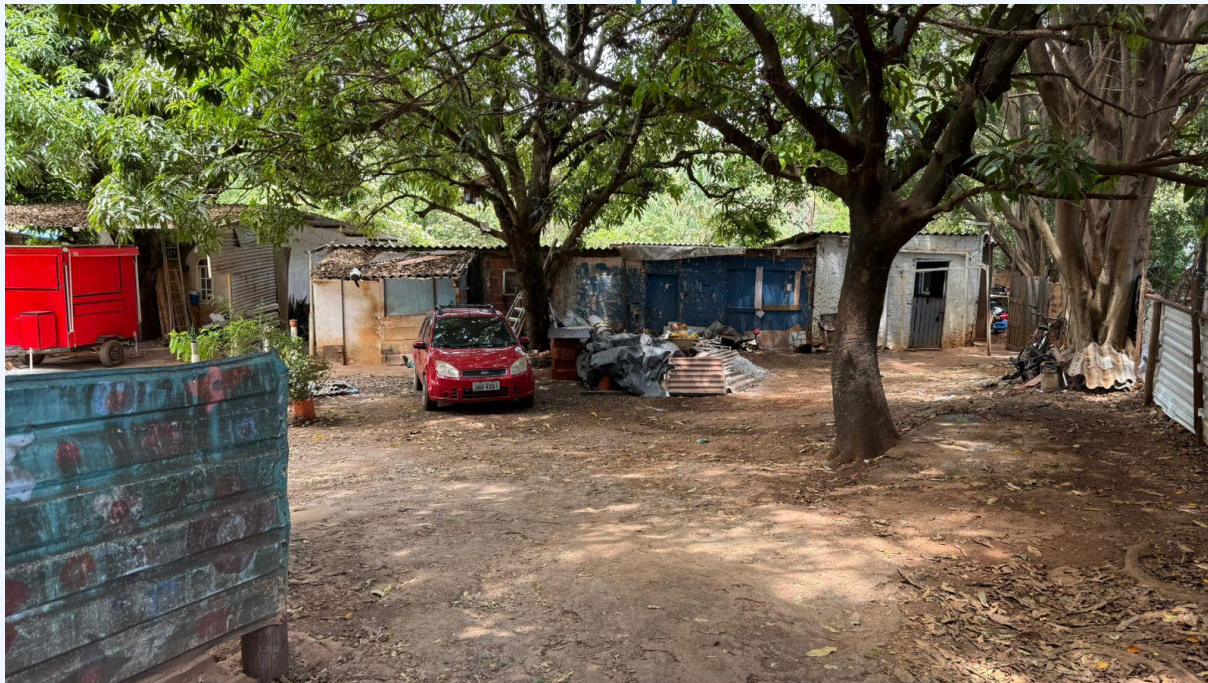
Fotografia 13 – Área sul da Vila Cultural Cobra Coral, Asa Sul, RA Plano Piloto, DF, com predominância de unidades residenciais construídas com vedações em madeira, material reaproveitado, placas de madeirite compensado, placas de alumínio e papelão
