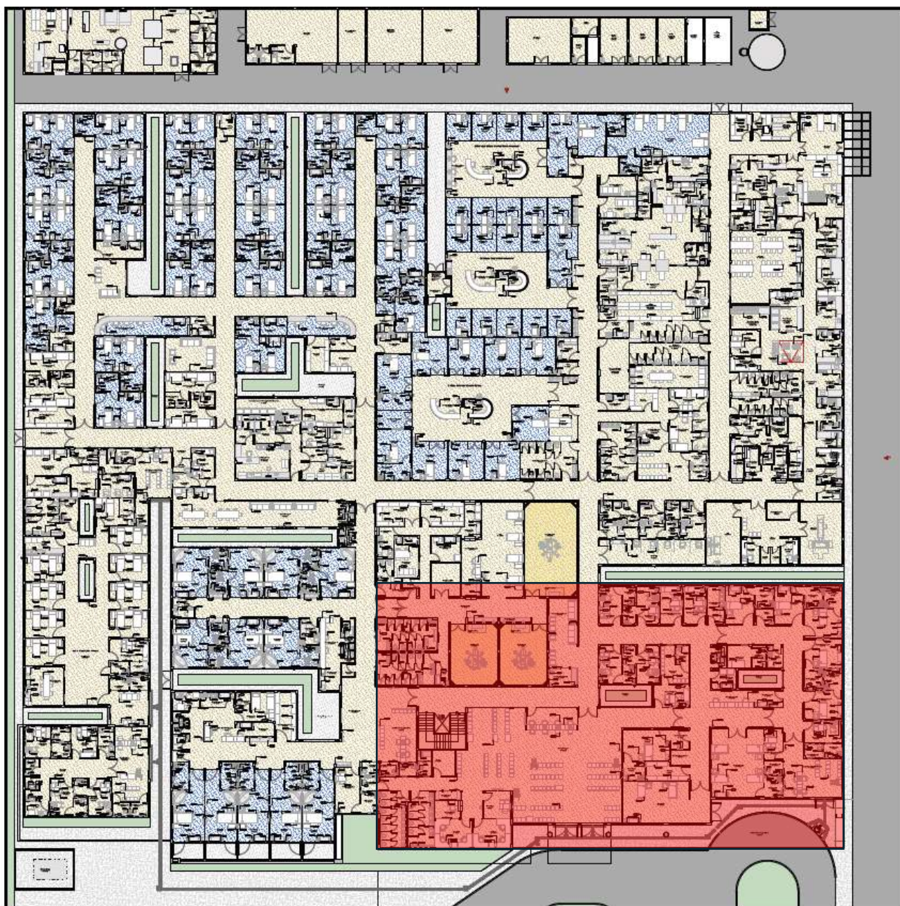
Figura 1 – Planta completa de layout do pavimento térreo da maternidade Porte I (modelo)
