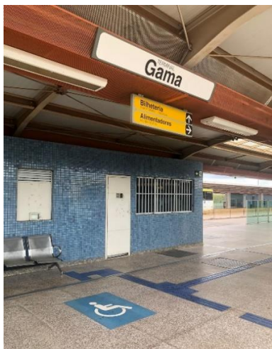
Figura 9 – Sinalização horizontal e piso tátil divergente com a organização espacial Fonte: Autoria própria
