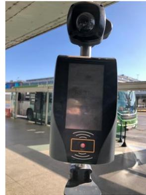
Figura 61 - Validador de cartão mobilidade, modelo V6, instalado na plataforma B – BRT, que possibilita passar cartão de crédito/débito.
